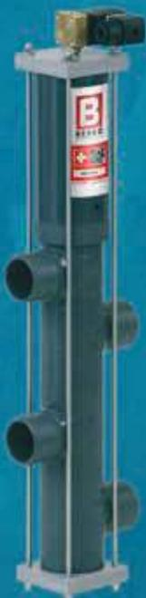
4-Wege-Ventil, **inklusive** 3/2 Magnetventil, 230 V, ¼", mit Handnotbetätigung. Für die Umschaltung des Bypasses zur Solaranlage
