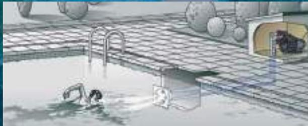
Installation über dem Wasserniveau möglich
