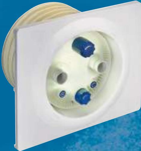
Durch ein im Becken bündig eingebautes Einbau- und Düsengehäuse aus Kunststoff wird mit einer über eine Saug- und Druckleitung angeschlossenen leistungsstarken BADU Pumpe Wasser angesaugt und mit einem kräftigen Strahl über zwei regelbare Düsen – allseitig um 60° schwenkbar – ins Schwimmbecken zurückgeführt.
